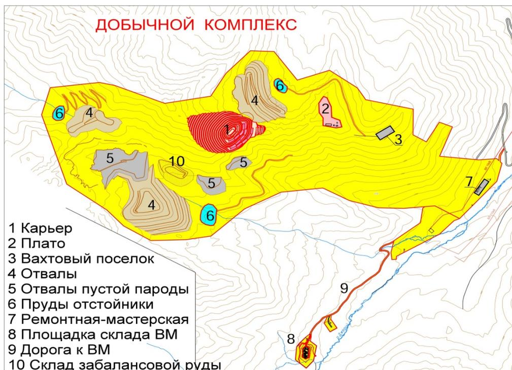
Рис. 4 Схема размещения объектов добычного комплекса
