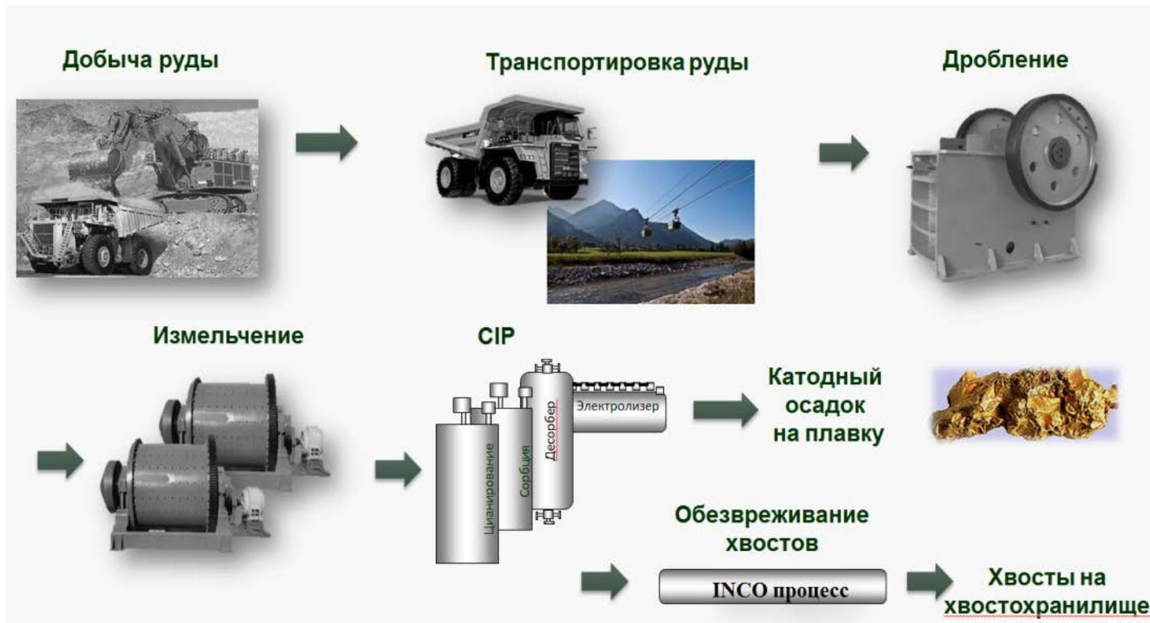
Рис. 6 Схема транспортировки и переработки руды
