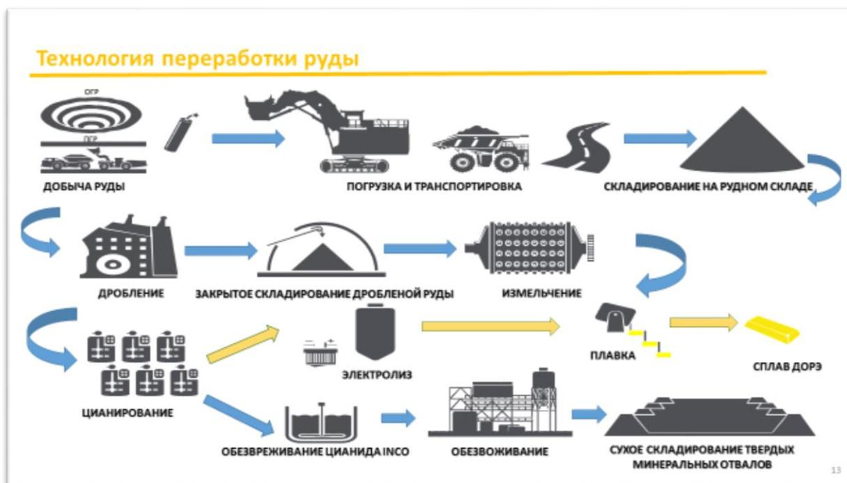
Рисунок 2-3: Упрощённая общая схема производственного процесса
